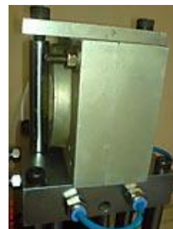
em seguida colocar a mufla Na máquina Odontoflex com o Bico de injeção para baixo. E cronometrar 12 min.
